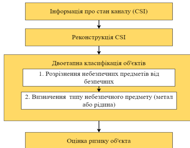
Рисунок 1 – Принцип роботи системи виявлення небезпечних предметів на основі CSI
