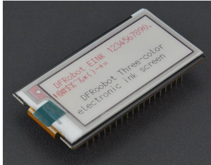
Рисунок 1 – Модуль DFRobot FireBeetle Covers-ePaper Black&White&Red Display Module
