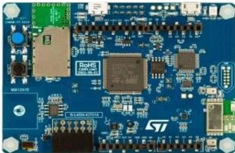
Рисунок 3 – Плата STM32 B-L4S5I-IOT01A Discovery IoT node (Arm Cortex-M4)
