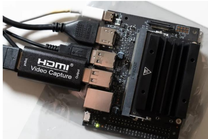
Рисунок 2 – Мікрокомп'ютер Jetson Nano з обчислювальною продуктивністю 472 GFLOPS
